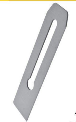
ΛΑΜΑ ΓΙΑ ΡΟΚΑΝΙ Προσαρμοσμένη στις 25 μοίρες έτοιμη για ακόνισμα Ατσάλι χρωμιωμένου άνθρακα για άριστη διατήρηση ακμών. Διάστ.: 44χιλ. για τα ροκάνια 1-12-203, 1-12-003 ΚΩΔΙΚΟΣ ΠΡΟΣ ΚΑΤΑΡΓΗΣΗ
