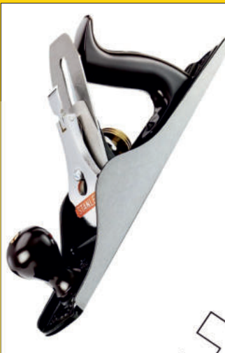
ΡΟΚΑΝΙ BAILEY JACK N° 5 Επαγγελματικό πλήρως ρυθμιζόμενο ροκάνι. Ροδέλα ρύθμισης βάθους κοπής, μοχλός στρέψης, κοχλίας κίνησης βάσης που επιτρέπει την αύξηση ή τη μείωση του αυλακιού. Επιχρωμιωμένο στοπ. Φινίρισμα από μαύρη λάκα. Χυτοπρεσσαριστή βάση, ρεκτιφιαρισμένη στις 3 πλευρές. Λαβή από συνθετικό υλικό. Δέχεται λάμες 0-12-313, 1-12-313.
